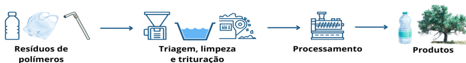
Figura 2: Ilustração do processo de reciclagem mecânica
