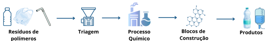
Figura 3: Ilustração do processo de reciclagem química
