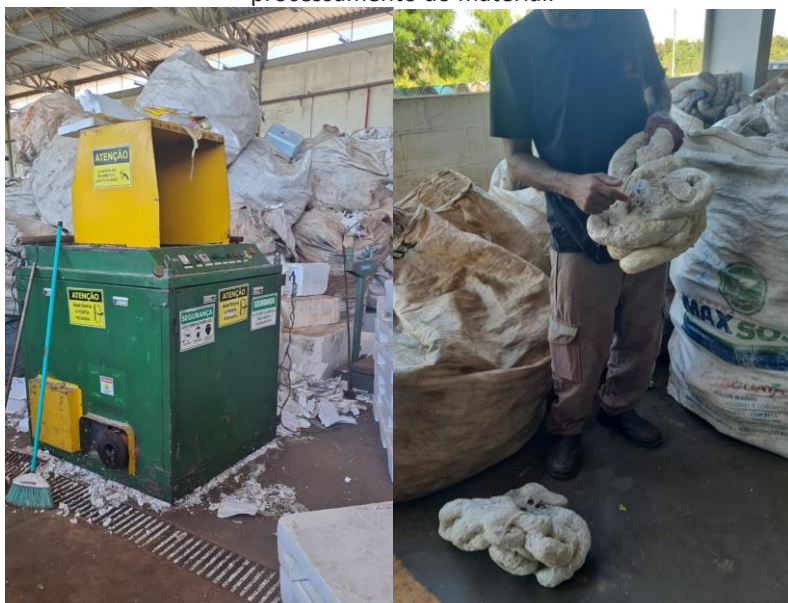
Figura 6: Máquina de reciclagem de isopor e produto final resultante após o processamento do material.
