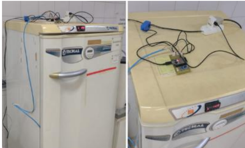
Figura 9 - Protótipo instalado na estufa 1
