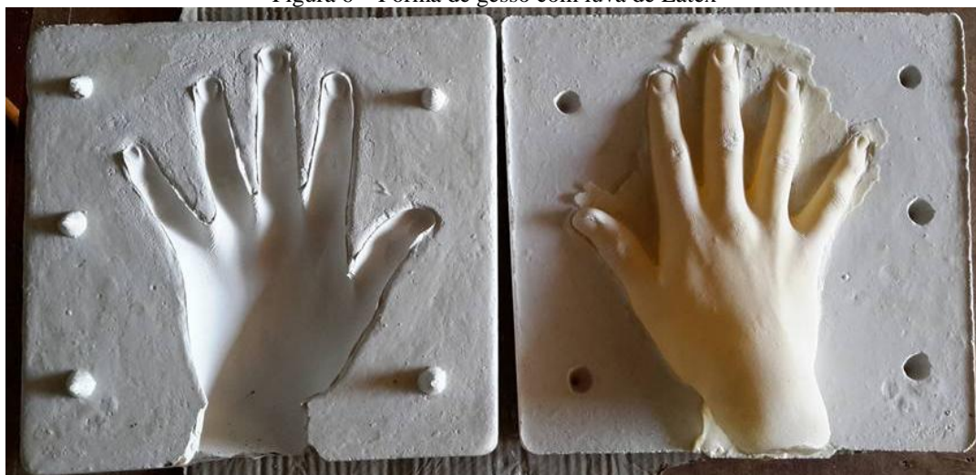
Figura 6 – Fôrma de gesso com luva de Látex
