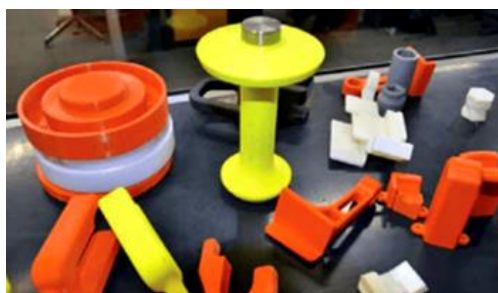
Figura 6 – Diversos gabaritos para auxílio em montagem fabricados em MA.
