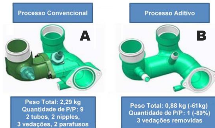
Figura 1 – Comparação entre manufatura subtrativa (A) e manufatura aditiva (B)
