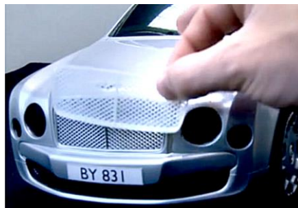
Figura 2 – Protótipo em escala reduzida via MA da Bentley .
