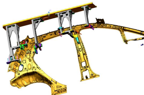
Figura 4 – Ferramenta construída em MA para montagem do veículo Chevy Bolt .
