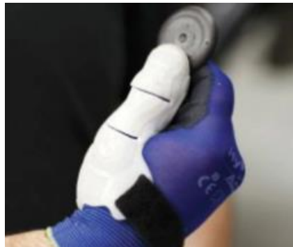
Figura 5 – Ferramenta construída em MA para montagens na fábrica da BMW .
