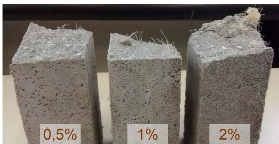
Figura 5 – Aparência dos corpos de prova após ruptura
