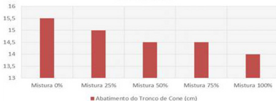
Figura 6 – Resultados obtidos no teste de slump
