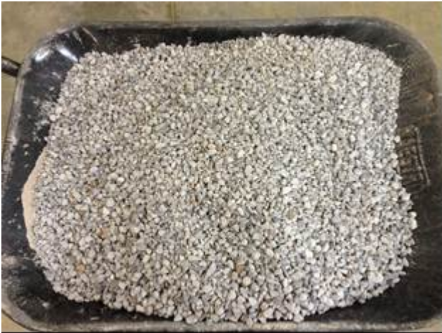
Figura 2 – Agregado graúdo utilizado na dosagem
