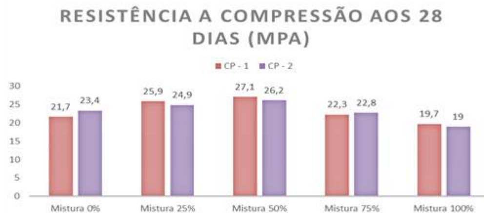
Figura 8 – Resultados obtidos no ensaio de compressão aos 28 dias
