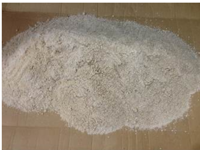
Figura 4 – Quartzito branco utilizado na dosagem
