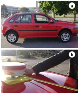
Figura 9 – (a) Veículo utilizado nos ensaios e (b) medição dos parâmetros para o posicionamento da antena.
