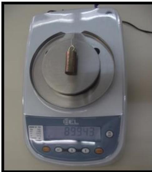
**Figura 3: medida da massa do corpo acelerador.**
