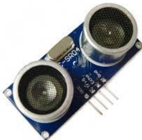
Figura 3 – Imagem do dispositivo HC-SR04 usado para medir distâncias
