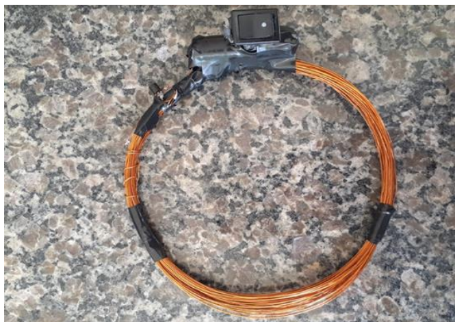
Figura 4 - Dispositivo gerador de campo eletromagnético variável
