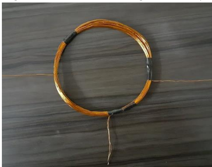
Figura 2 - Enrolamento dos filamentos geradores de campo
