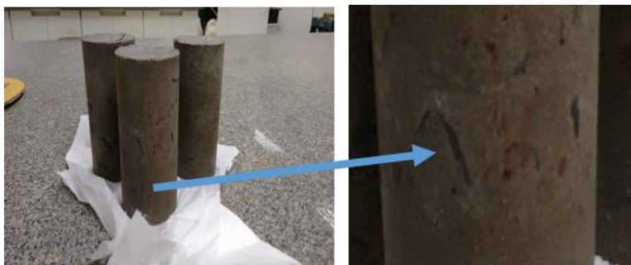
Figura 3 - Corpos de prova de resistência a compressão uniaxial
