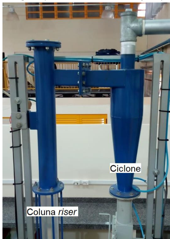
Figura 1: Região superior da unidade de fluidização rápida a frio
