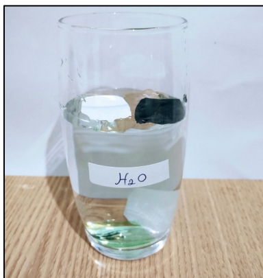
Figura 4 – Amostras de polímeros na solução de água potável
