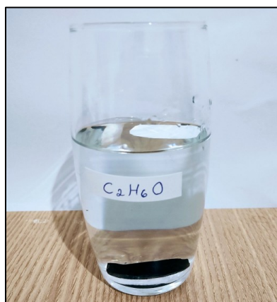
Figura 5 – Amostras de polímeros menos densos que a água na solução de etanol comercial
