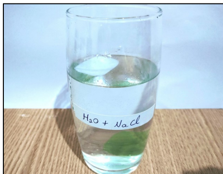
Figura 6 – Amostras de polímeros mais densas que a água na solução de água com sal
