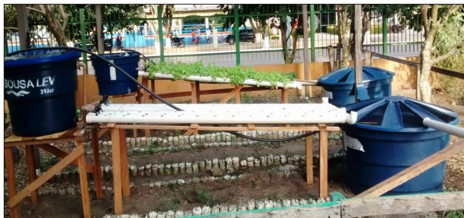
Figura 1 – Sistema aquapônico montado
