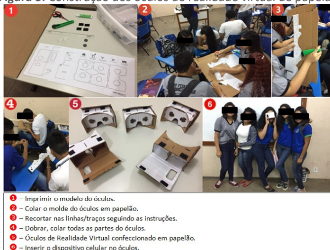
Figura 3: Construção dos óculos de realidade virtual de papelão.
