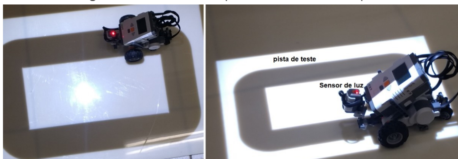
Figura 2 – Teste do sensor para reconhecimento da pista
