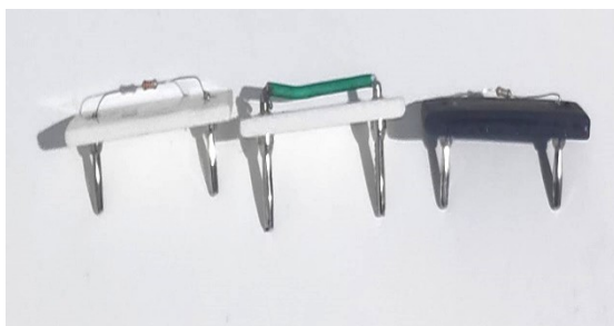
Figura 5: Resistores e fio fixados em placa desenvolvida em impressora 3D.
