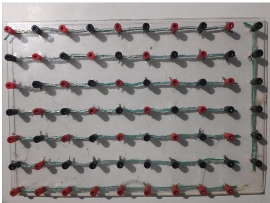
Figura 4: Quadro para construção de circuitos elétricos.
